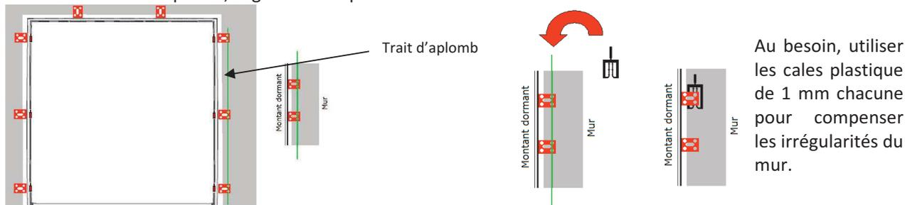
Engorder la porte sur le montant fixé, et la refermer de manière à contrôler les jeux de fonctionnement. Répéter l'opération de vissage des équerres au mur, à l'aide d'un nouveau trait d'aplomb, pour le 2<sup>ème</sup> montant. Engorder la 2<sup>ème</sup> porte, et la refermer de manière à contrôler les jeux de fonctionnement.
