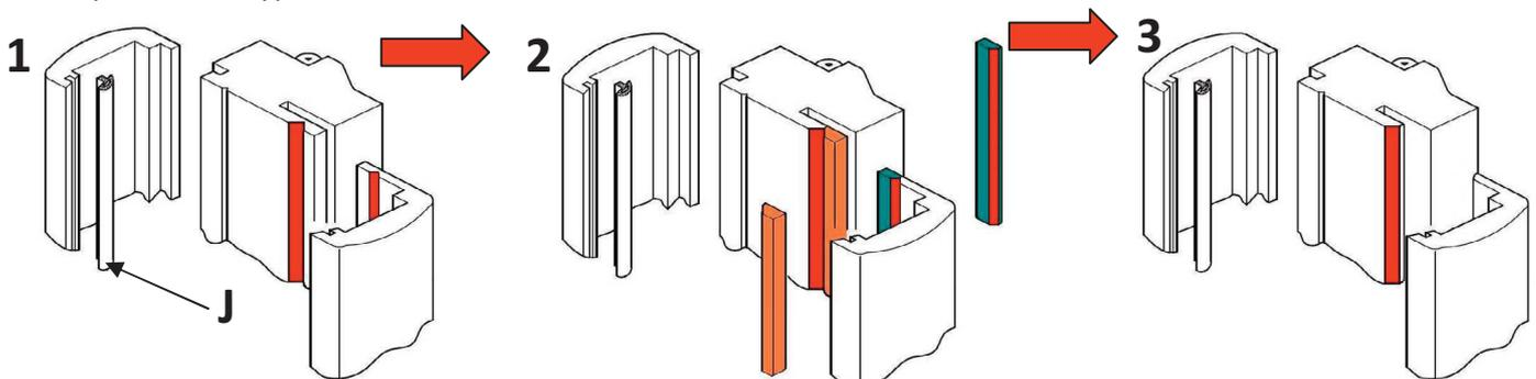
Clypsò peut aussi s'adapter à des cloisons plus étroites ou des cloisons d'épaisseur variable (présence de carrelage par exemple) en intégrant un joint (optionnel) dans les rainures à l'arrière des chambranles et contres chambranles (noté « J »).
