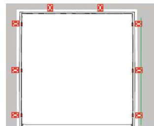
Procéder à la mise à dimension du joint des 2 montants : celui-ci doit être recoupé sur la partie en contact avec la traverse haute pour permettre l'assemblage final. Utiliser le gabarit fourni qui permet une mise à longueur rapide et fiable.
